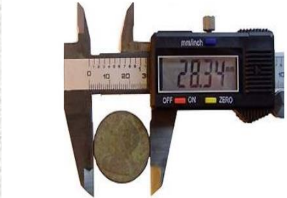
لوحة (١٣٣) صورة تمثل البوكليز الرقمي Digital Vernier
